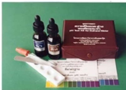
รูปภาพที่ ๔๔ แสดงชุดตรวจสอบความเป็นกรด-ด่างของดินและน้ำ ที่มา: สุเทพ ทองแพ. (๒๕๕๑).
